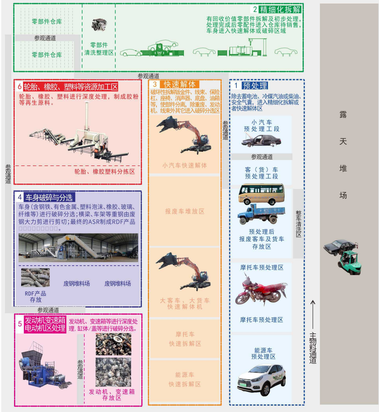
年处理2万台报废汽车工厂布局示意图
